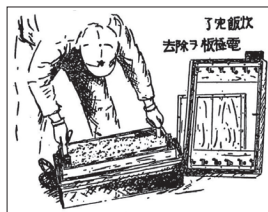
図 2-4 九七式炊事自動車の電極式炊飯器の取り扱い方（給養器具取扱説明書） 8)
